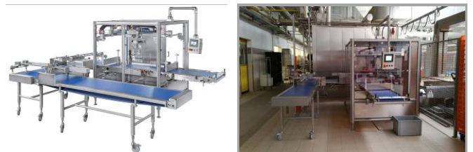
Abb. Ultracut Terbia Duo mit Transportbändern als U-Rückführung
