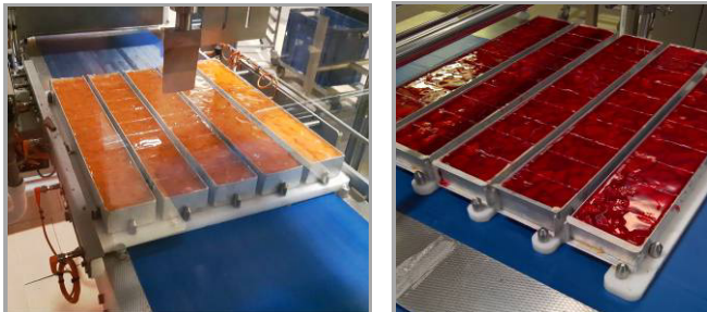
Abb. Trägerplatte mit 5 Stück 100x600mm Kuchenblechen
